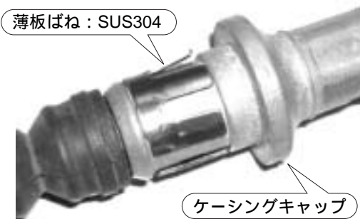
図2 パーキングブレーキ用薄板ばね
