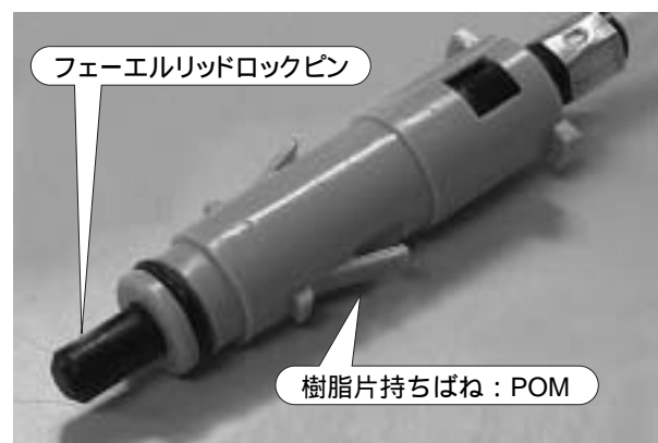
図4 フューエルリッドロックケーブル
