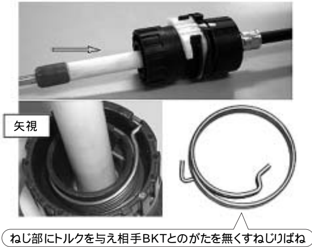
図5 がた詰めワンタッチ取付構造
