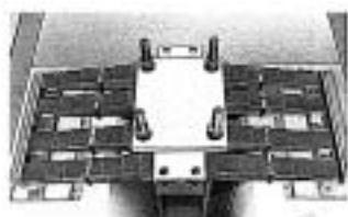
図4 重ね板ばねを用いた防振装置
